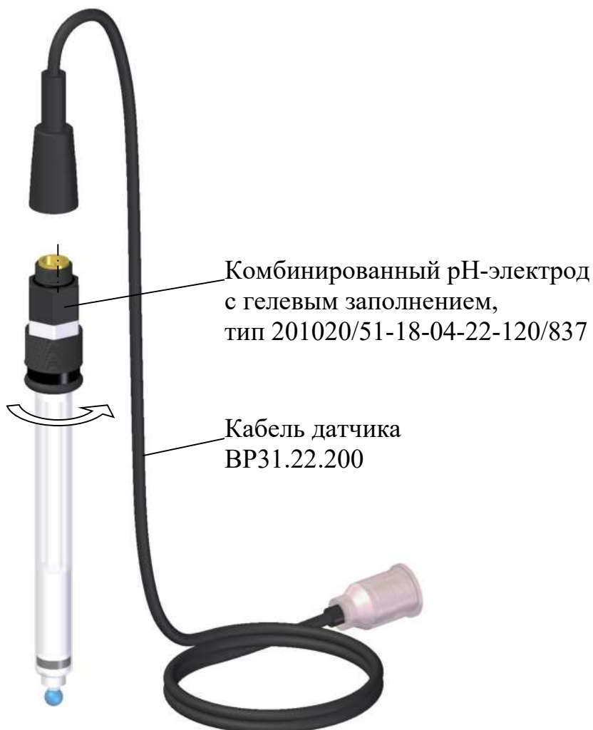
Рисунок 2.3 – Подсоединение кабеля датчика к электроду
