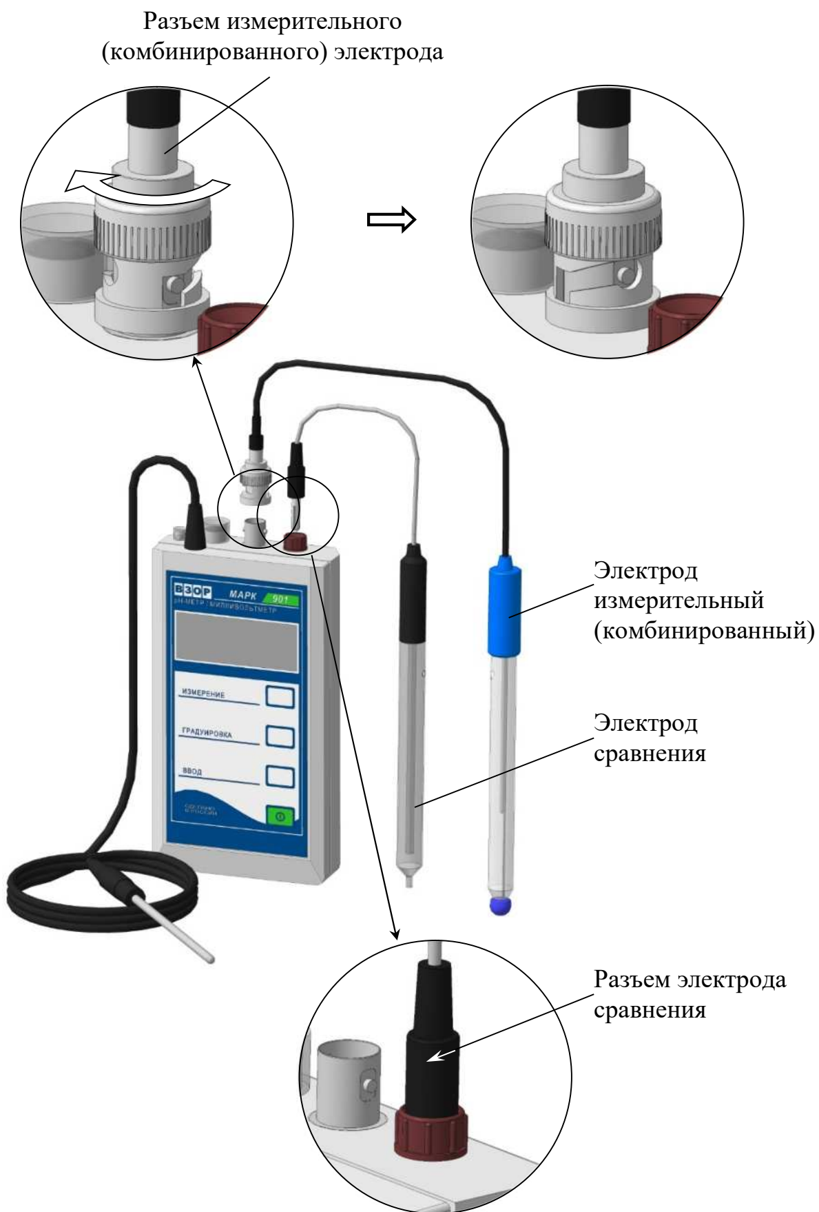
Рисунок 2.4 – Установка электродов
