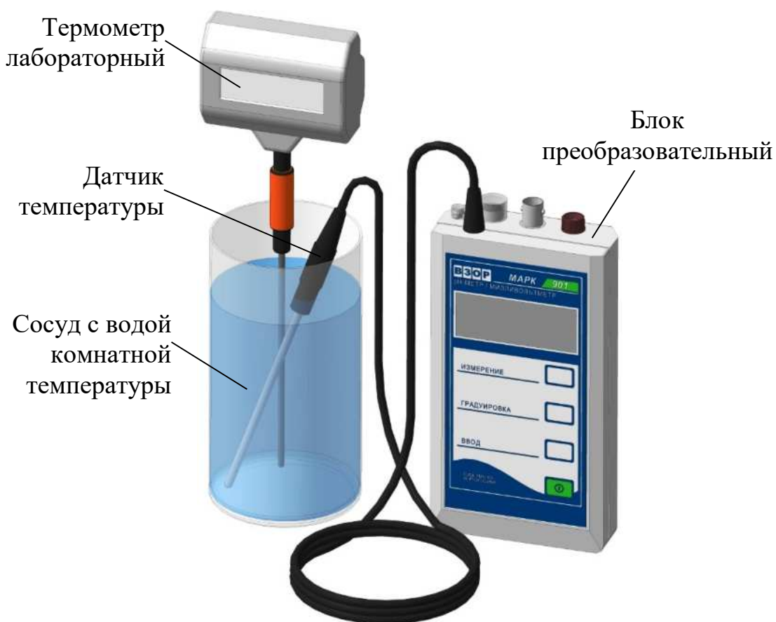
Рисунок 3.2 – Проверка показаний по температуре
