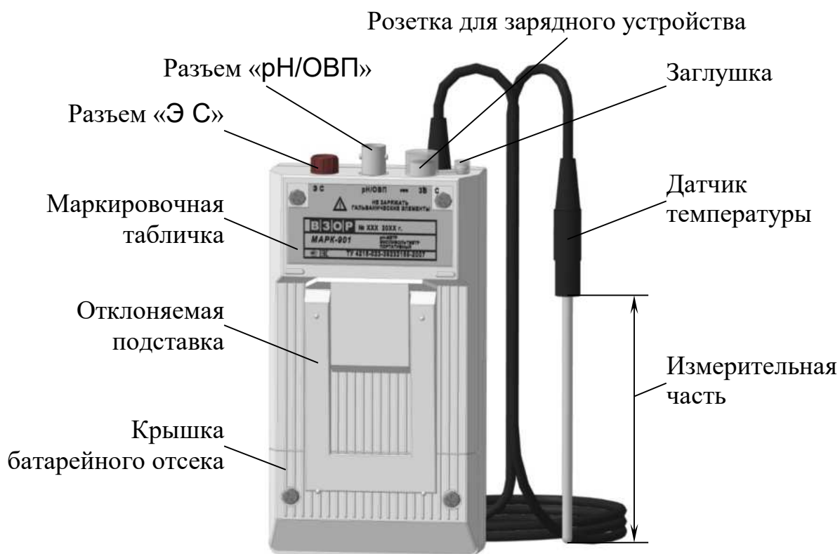
Рисунок 1.2 – Блок преобразовательный (вид сзади)
