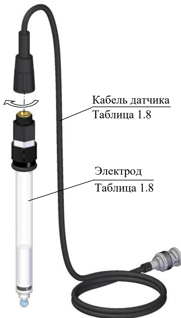
Рисунок 1.9 – Подключение кабеля датчика к комбинированным электродам
