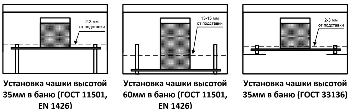
Рисунок 9– Установка перфорированной подставки и термометра
