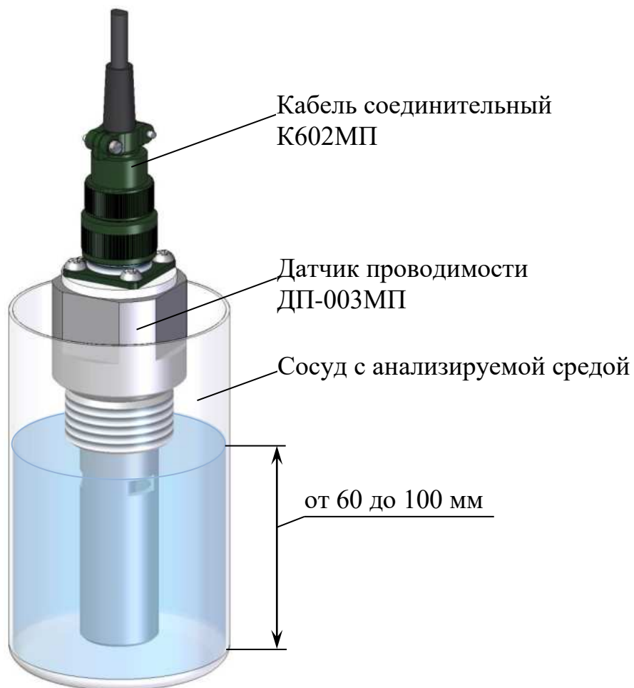
Рисунок 2.8 – Расположение датчика проводимости ДП-003МП в сосуде
