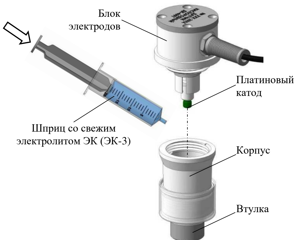
Рисунок 2.7 – Заливка электролита в датчик ДК-409Т, ДК-409ТМ
