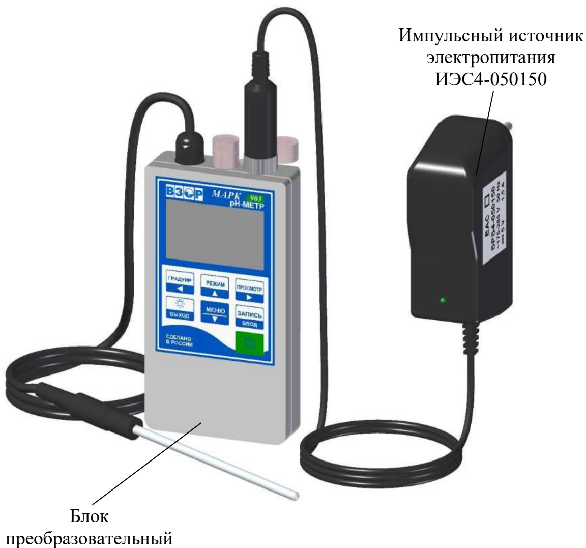
Рисунок 3.1 – Зарядка аккумуляторных батарей
