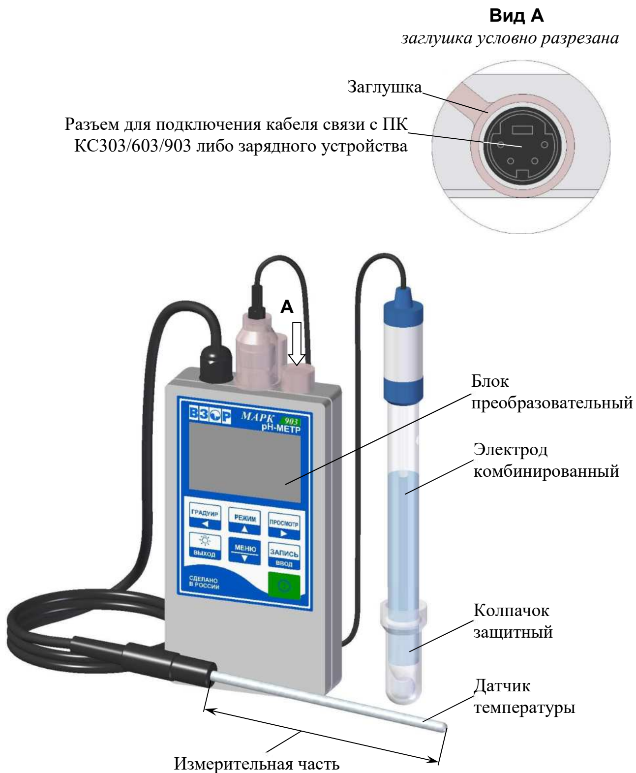
Рисунок 1.1 – pH-метр МАРК-903 (вид спереди)
