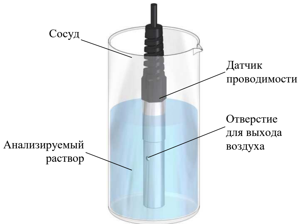
Рисунок 2.3 – Проведение измерений погружным методом
