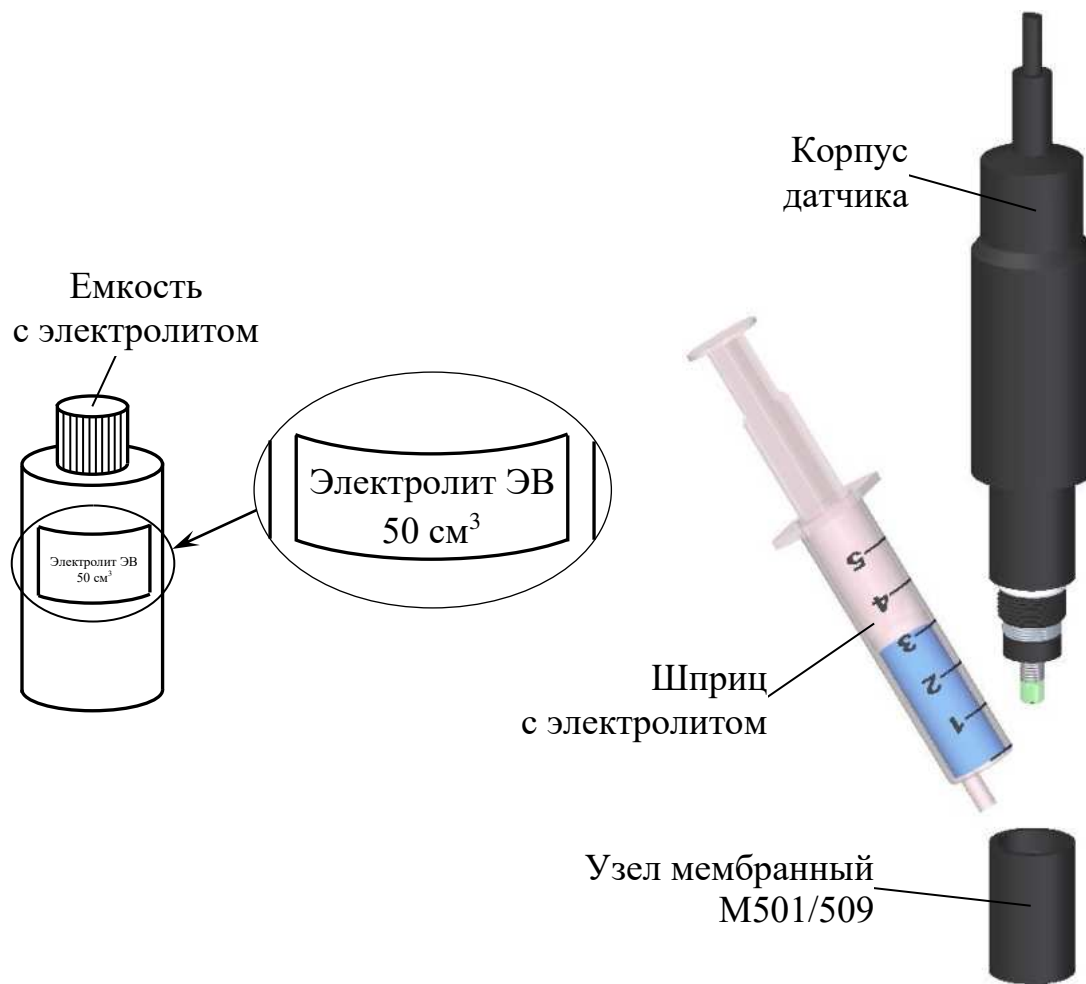
Рисунок 2.7 – Заливка (добавление) электролита
