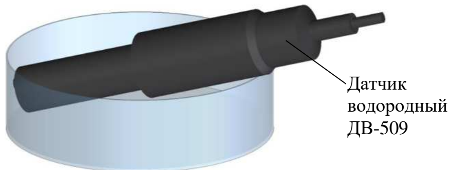
Рисунок 2.8 – Расположение датчика водородного ДВ-509 на воздухе
