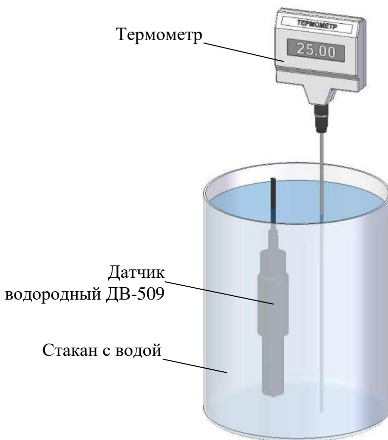
Рисунок 3.2 – Проверка показаний по температуре
