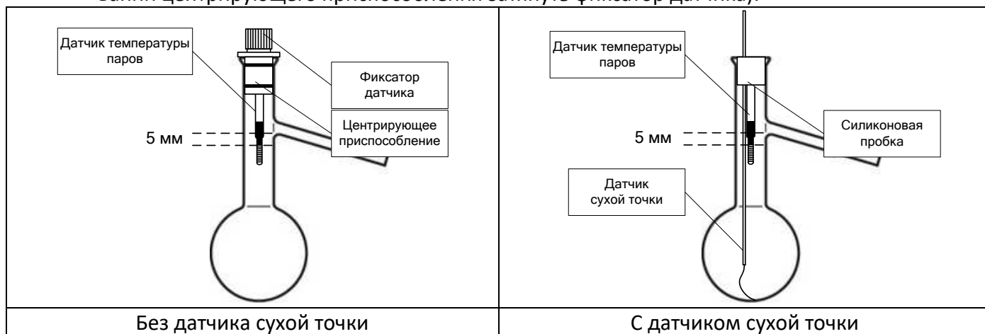
Рисунок 7 – Установка датчика температуры паров
