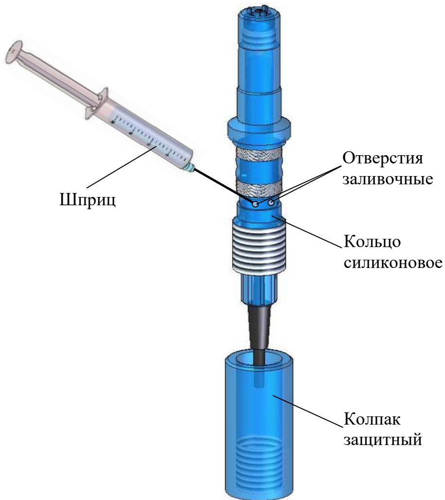
Рисунок 3.1 – Замена электролита ЭК
