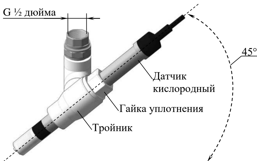
Рисунок 2.9 – Держатель датчика с установленным датчиком кислородным
