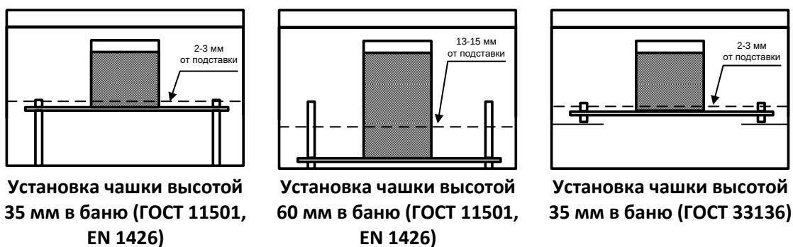
Рисунок 7 – Установка перфорированной подставки и термометра
