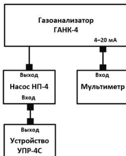
Рисунок А.1 – Схема проверки газоанализатора с диффузионным забором пробы
