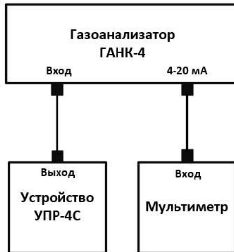
Рисунок А.2 – Схема проверки газоанализатора с принудительным забором пробы
