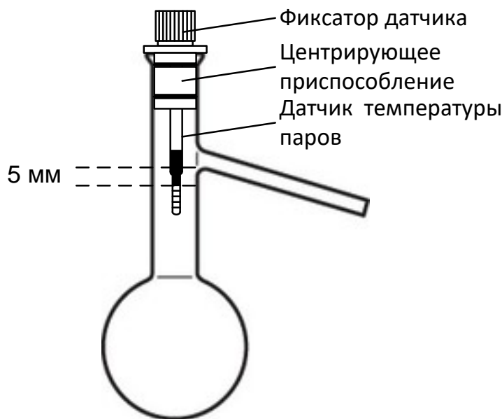
Рисунок 8 - Установка датчика температуры паров в центрирующем приспособлении
