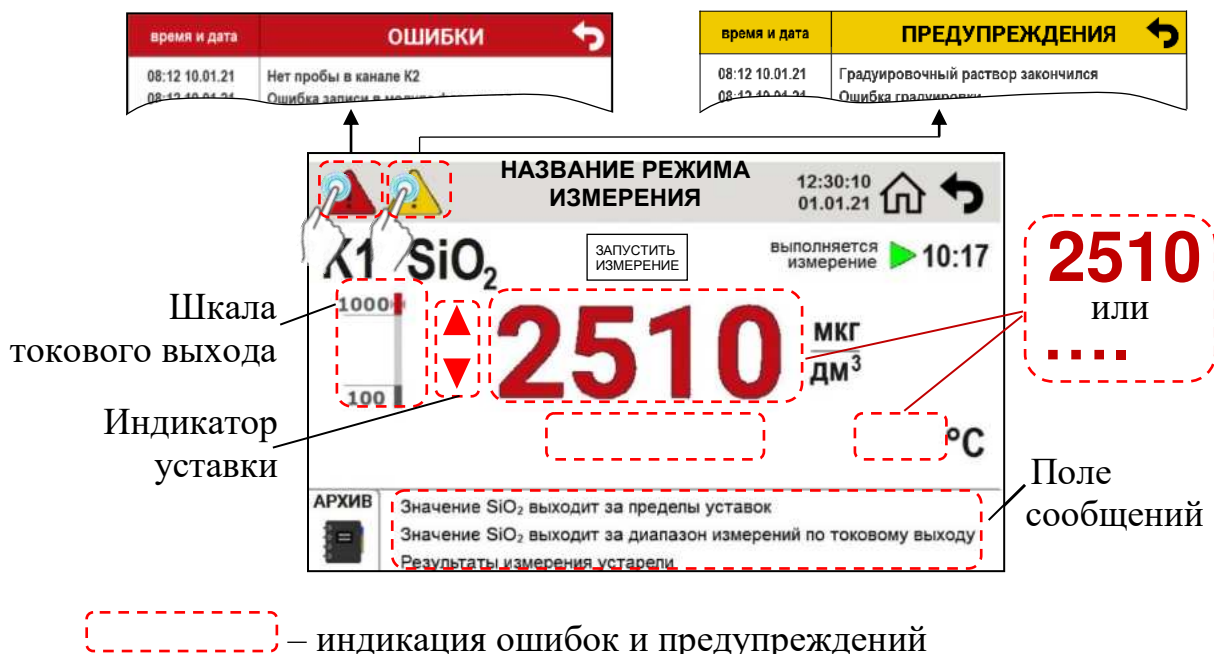
Рисунок 2.3 – Индикация ошибок и предупреждений
