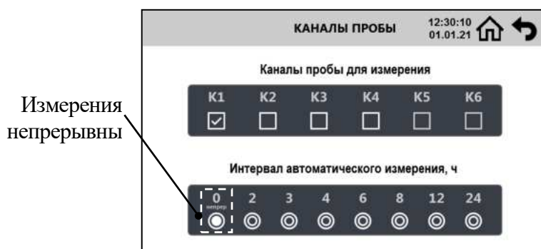
Рисунок Г.16 – Экран «КАНАЛЫ ПРОБЫ»
