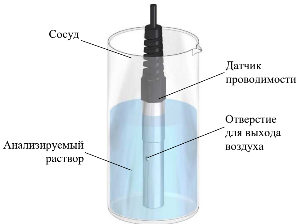
Рисунок 2.3 – Проведение измерений погружным методом
